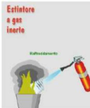
La sua azione estinguente si sviluppa principalmente per soffocamento (in quanto nel passaggio dallo stato liquido a quello aeriforme, sottrae ossigeno alla combustione), e solo in parte minore per raffreddamento.
